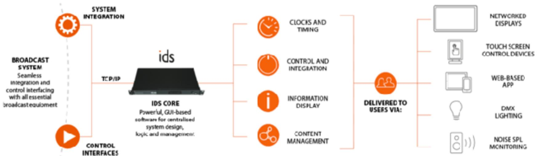
IDS est une solution matérielle et logicielle qui permet d'interconnecter plusieurs systèmes broadcast et d'afficher les informations souhaitées sur des écrans ou de déclencher des événements sur des systèmes lumineux.
